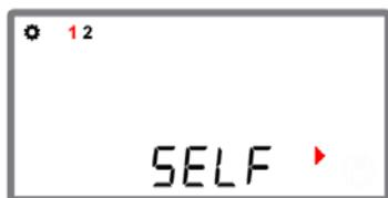
Appuyez une seconde fois sur le bouton «valider» pour engager le Self-test. Le signe de fonctionnement est affiché lorsque la machine effectue l'opération.
