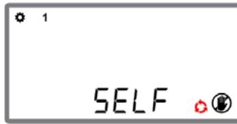
Si aucune erreur n'a été détectée durant le Self-test, l'affûteur renverra le message «SELF ✓» et la led clignotera vert.
