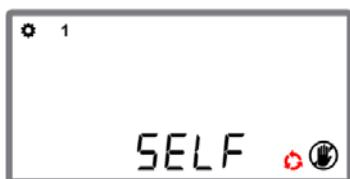
Se non sono stati rilevati errori durante l'autotest, l'affilatrice restituisce il messaggio "SELF ✓" e il LED lampeggia in verde.
