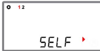
Premere una seconda volta il tasto "valider" per attivare l'Autotest. Il simbolo di funzionamento viene visualizzato quando la macchina sta eseguendo l'operazione.
